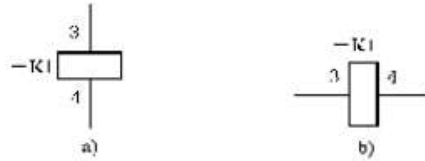
图 11 端子代号的标注方式
