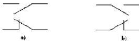
图10 水平放置时触点的表示方式
