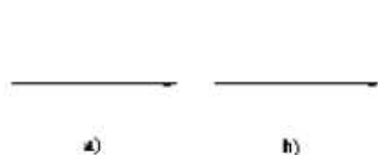
图3 带箭头的信号线和连接线
