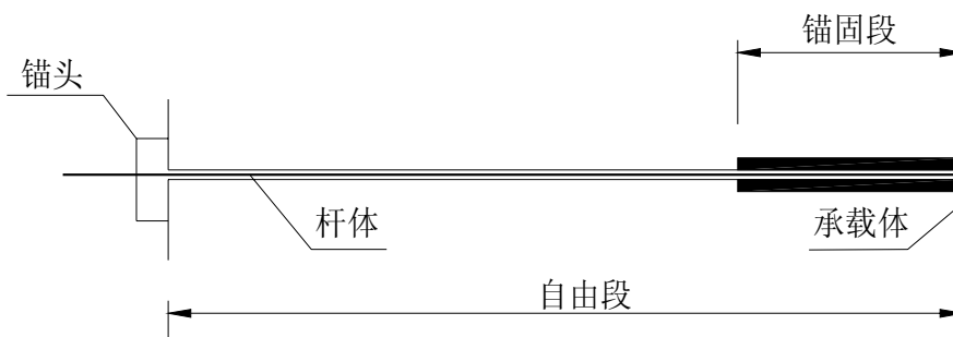
图 7 压力集中型预应力锚杆结构示意图
