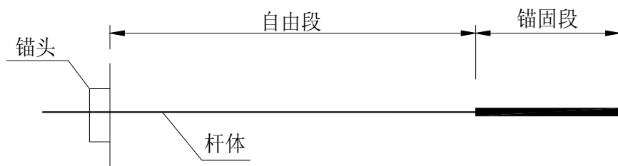
图 6 拉力集中型预应力锚杆结构示意图
