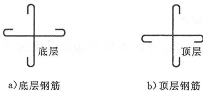
图 4.3.5-1 平面图中的双层钢筋
