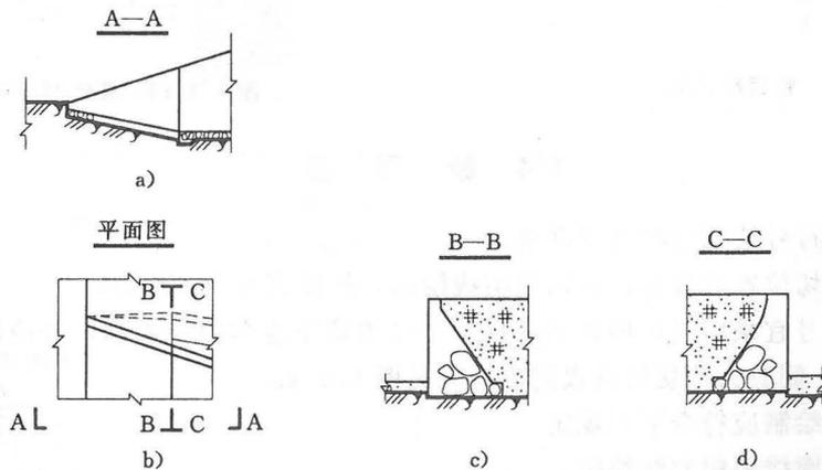
图 4.4.4 结构突变处的断面
