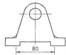
图 5.2.1-5 圆弧光滑过渡处尺寸界线的引出示例
