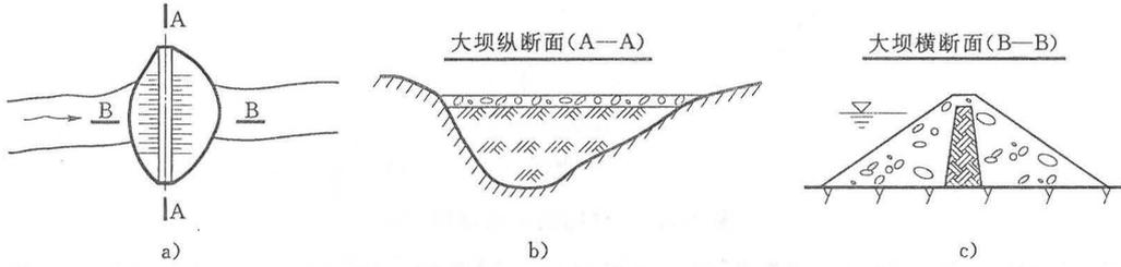
图 4.4.5-2 建筑物的纵断面和横断面
