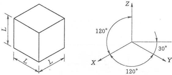
注:  $p=q=r=1$ ,  $p, q, r$  为 X、Y、Z 轴向变形系数。
