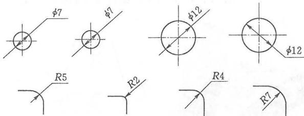
图 5.2.2-2 小圆直径、半径注法
