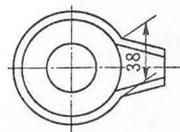
图 5.2.1-1 尺寸界线与尺寸线不垂直的示例
