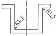
图 4.6.2-6 小倒圆简化画法 (单位: mm)
