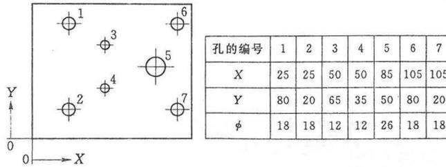
图 5.3.5-2 用坐标法标注尺寸
