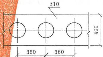
图 5.2.11 板状构件厚度的标注方法
