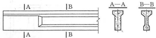
图 4.4.2-4 应标注的移出断面
