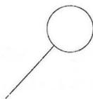
图 3.5.4-1 引线和索引编号、详图编号
