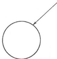
图 3.5.4-6 引线终端指向轮廓线上
