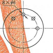
图 5.3.2-2 均布构造尺寸注法
