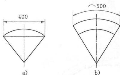
图 5.2.2-4 弦长、弧长的注法
