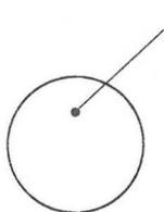
图 3.5.4-5 引线终端指向轮廓线内
