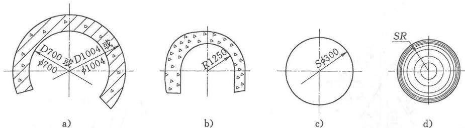
图 5.2.2-1 圆直径注法
