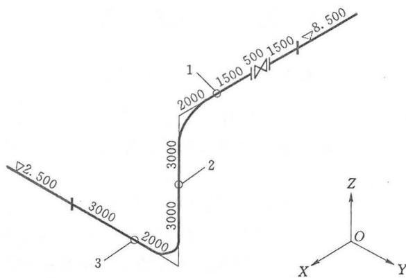
图 4.9.5 管路系统图 (单位: cm)
