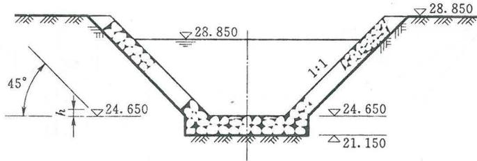
图 5.2.7-1 立面图、剖视图、断面图标高注法
