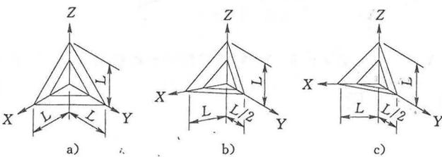
图 4.9.3-2 轴测图中剖切面图例画法
