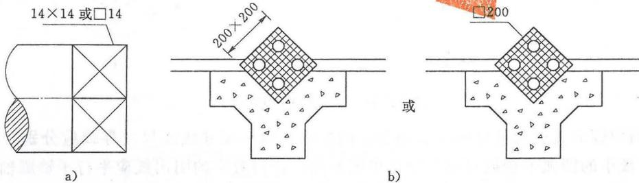
图 5.2.12 正方形结构尺寸注法
