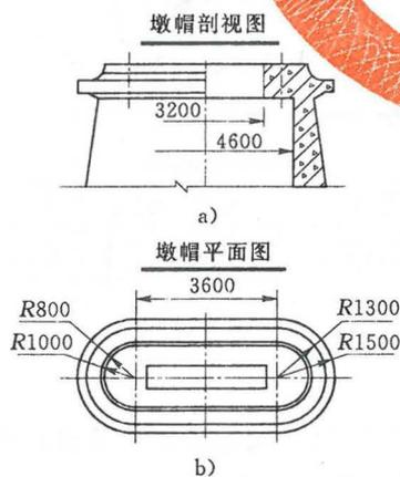
图 5.2.1-7 对称构件尺寸标注
