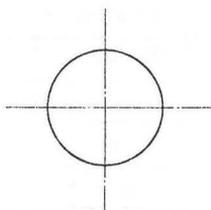
图 3.5.3-1 圆的中心线
