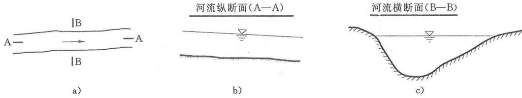
图 4.4.5-1 河流的纵断面和横断面
