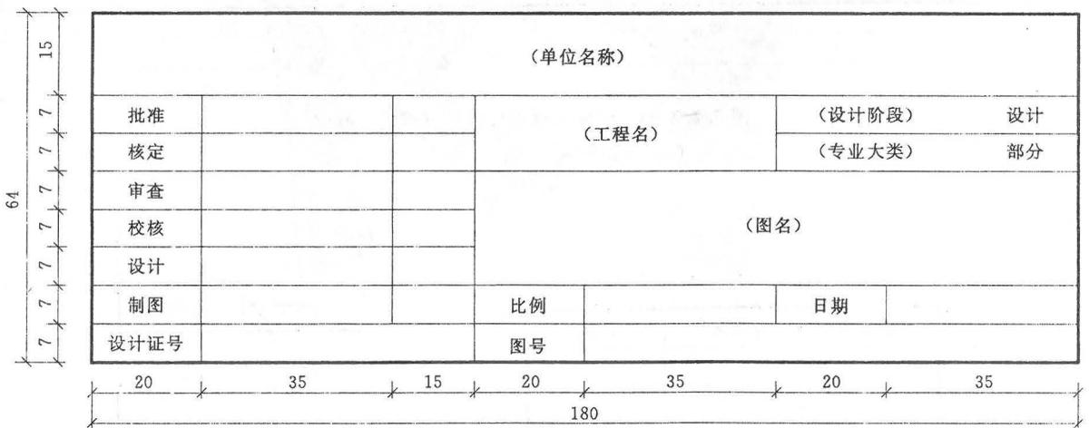
图 3.2.3-1 A0、A1 幅面标题栏（单位：mm）
