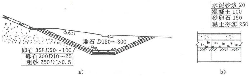
图 5.3.1 多层结构注引线标注法
