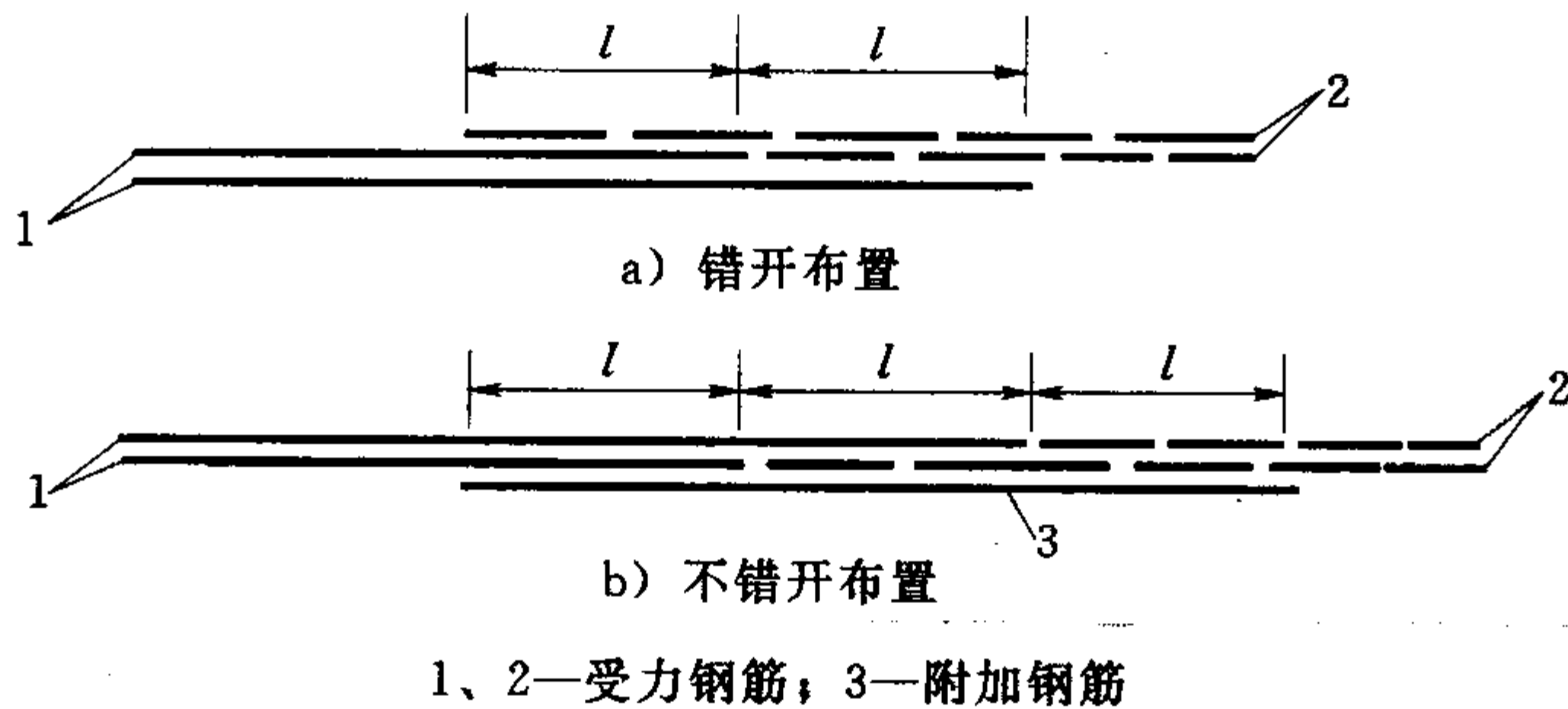
图 9.4.7 2 根束钢筋的搭接方式
